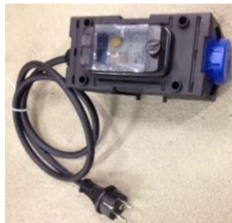
Zwischenstecker mit integriertem Fehlerstromschutzschalter
